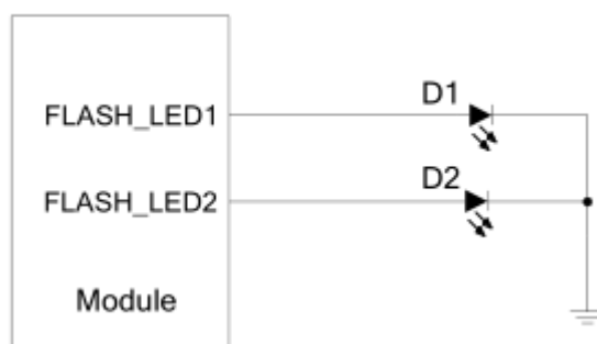
图 31 Flash light 接口参考电路
